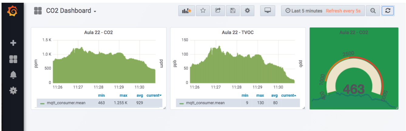
Figure 5. Ejemplo de un dashboard de Grafana mostrando valores de CO2 y TVOC.
